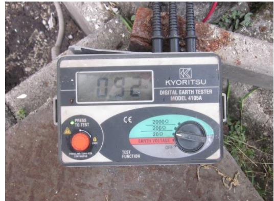
Pengujian tahanan pembumian
