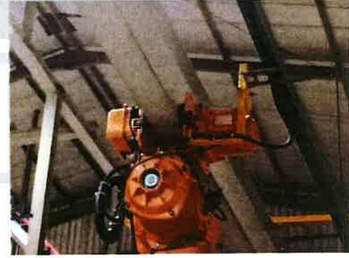
Pemeriksaan visual pada hoist dan trolley
