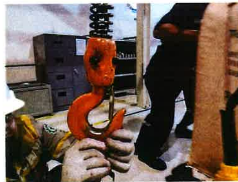
Pemeriksaan visual pada load hook dan load chain
