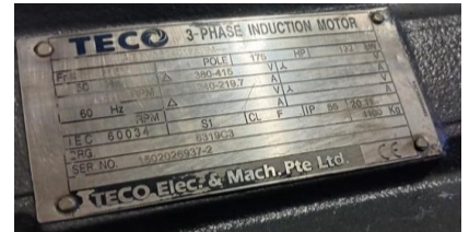
Foto Nameplate Motor
