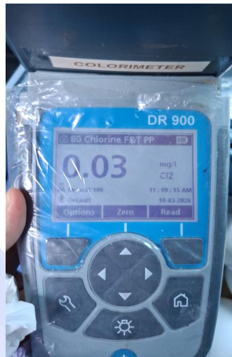
Free chlorine chiller A 0,03 ppm
